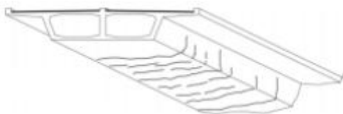
< PSC 박스거더의 균열 >
